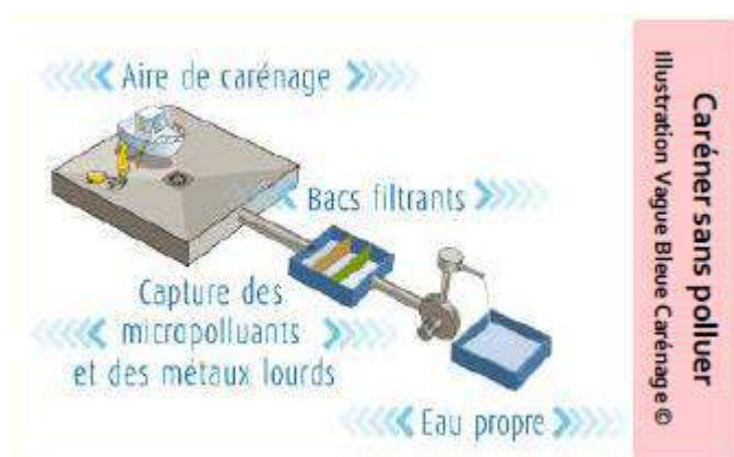
Figure 12 : Description d'une zone de carénage aux normes
