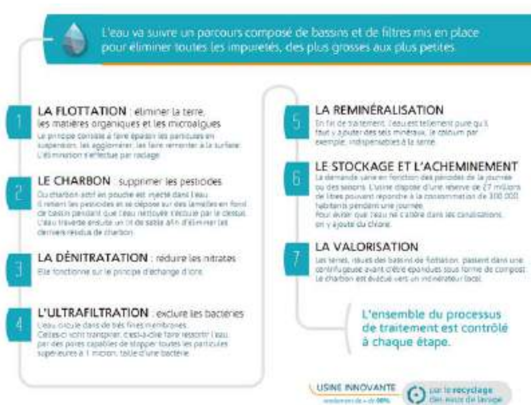
Figure 23 : Les traitements de l'eau brute dans l'usine de Pléven (source : SMAP)
